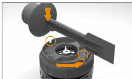
Mit Hilfe von Rührspatel, schrauben Sie die Basis ab. Zerlegen Sie alle abtrennbares Stücke, ohne Dichtungsring zu vergessen.
