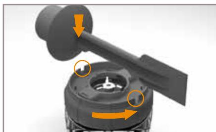
Con l'aiuto della spatola, svitate la base. Smontate tutti i pezzi che si staccano senza dimenticare la guarnizione.
